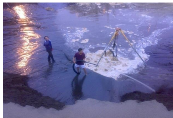
Gambar 3. Pelunakan material sebelum dinaikan ke alat magnetic separator
