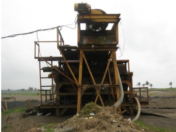
Gambar 4. Pemisahan material pengotor pada sieve trommol
